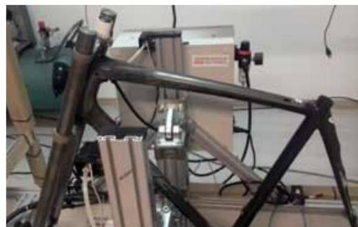
Après réparation, le cadre Time est testé au banc d'essai CADRIX.
